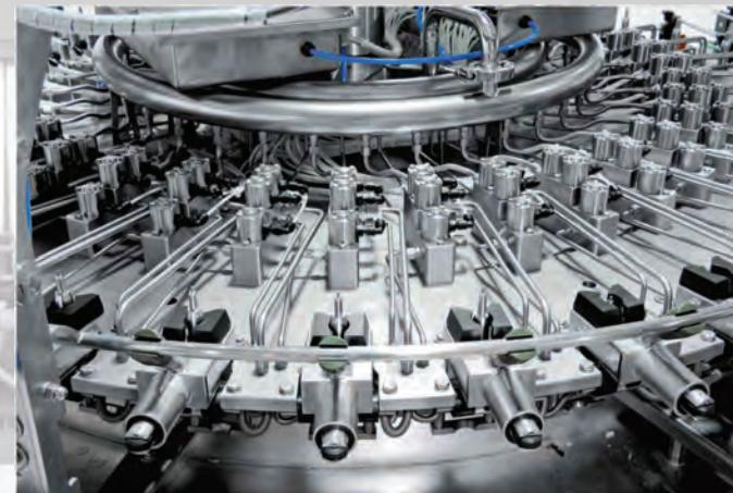
Модель DE может выполнять несколько процедур: от ополаскивания водой до стерилизации надуксусной кислотой или перекисью водорода, в т.ч. обогащенной солями серебра, а также осуществлять продувку стерильным воздухом с целью уменьшения остаточного содержания жидкости.
