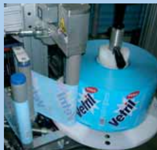
Reel holder with nonstick rollers. Rollenhalterung mit nichthaftenden Walzen. Бобинодержатель с противоприлипающими валиками.
