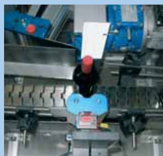
Electro - Pneumatic rotation system. Elektropneumatisches Drehsystem. Система электро-пневматического вращения.
