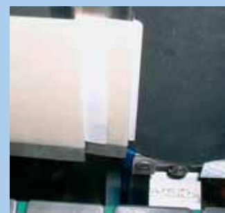
Bottle Centering with optic fiber to have a better precision. Präzise Flaschenzentrierung mit Glasfaser. Центрирование бутылки с оптическим волокном, для большей точности.
