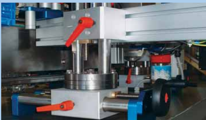
Regulation of labelling units with 3 axes adjustment. 3-Achsenverstellung. Регулировка групп этикетирования системой с 3 осями.
