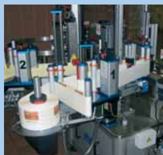
Labeling unit 40 MT / Min. Etikettierstation 40m/min. Группа этикетирования 40 м/мин.
