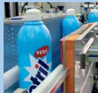
Vacuum Belt for label transfer. Vakuumband zum Etikettentransfer. Коврик с аспирацией для перемещения.
