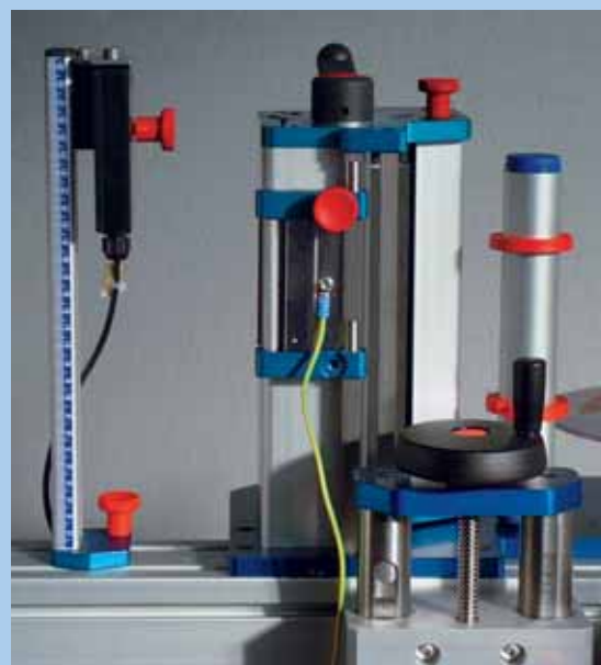
Photo-stop unit with antistatic brake. Stoppeinheit mit Photozelle und Antistatik-Bremse. Группа фотостоп и антистатический тормоз.
