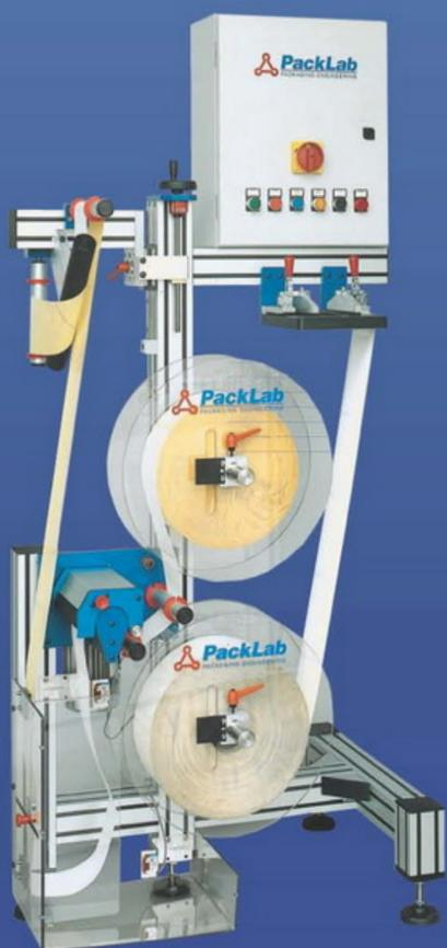
Опционально возможно укомплектовать роторный этикетировочный автомат увеличенным магазином этикеток, с возможностью работы с бобиной диаметром до 500 мм, а также системой контроля этикетки с устройством отбраковки, системой вертикального открытия ограждений безопасности с круглой станиной и т.д.
