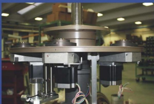
Установленные пошаговые привода компании Oriental Motor (made in Japan) позволяют точно и гибко вращать тарелку с бутылкой согласно заданной программе. Установленный сенсорный экран управления позволяет оперативно изменять программу под текущие задачи.
