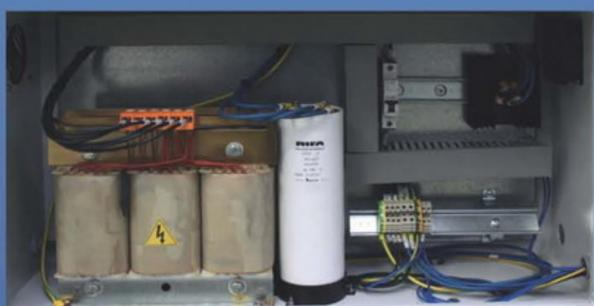
В нестабильных условиях эксплуатации на Российских предприятиях, индукционный стабилизатор напряжения питания позволяет максимально обезопасить работу машины от скачков напряжения.
