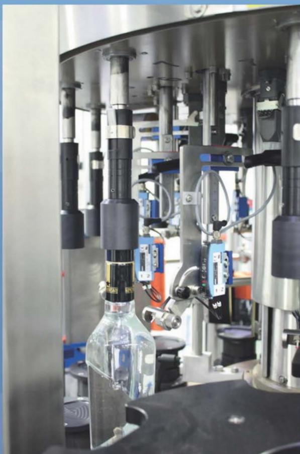
Каждая тарелка укомплектована волоконно-оптическим датчиком компании Datalogic (made in EU).
