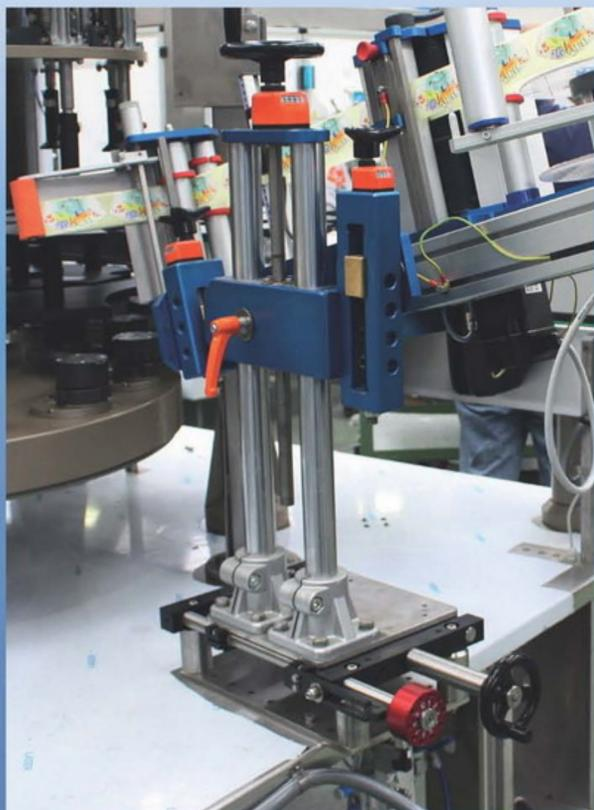
Новая регулировка в пяти плоскостях (4 механические +1 электрическая) с «памятью» позиций позволяет наносить этикетку в том числе и на бутылки, имеющие сложные конические и овальные формы, а также жестко держит аппликатор на станине.
