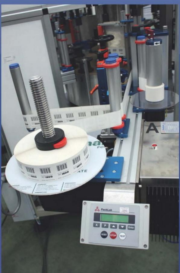
Аппликаторы серии MODULO предназначены для нанесения самоклеющейся этикетки. В зависимости от скорости устанавливаются следующие модели 40/60/90/120 метров в минуту. Благодаря модульной системе аппликатор требует минимальное количество инструментов для обслуживания, а загрузка этикетки происходит быстро и четко. Специальные версии аппликаторов позволяют работать с этикеткой, имеющей высоту до 295 мм.
