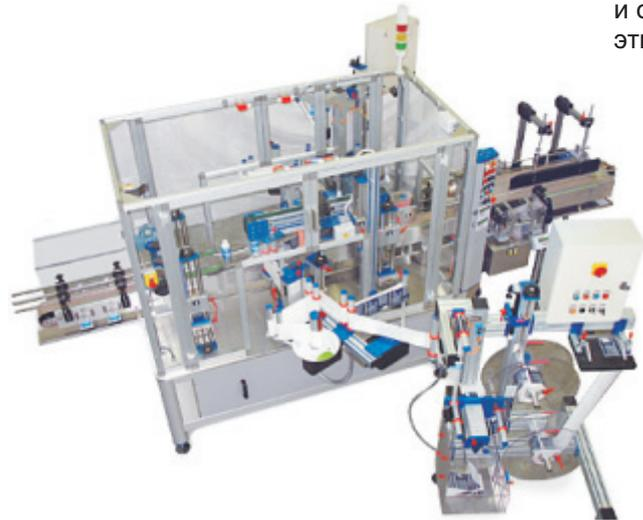
**Линейная машина для самоклеющихся** этикеток предназначена для нанесения этикеток на верхнюю и нижнюю часть контейнера, а также этикетки и контр-этикетки на квадратный, либо овальный контейнер. Модульная конструкция машины и применение станций самоклеющейся этикетки обеспечивают простоту регулировок на различные форматы контейнеров в соответствии со специфическими требованиями. Применяемые аппликаторы обеспечивают высокую точность нанесения этикетки.
