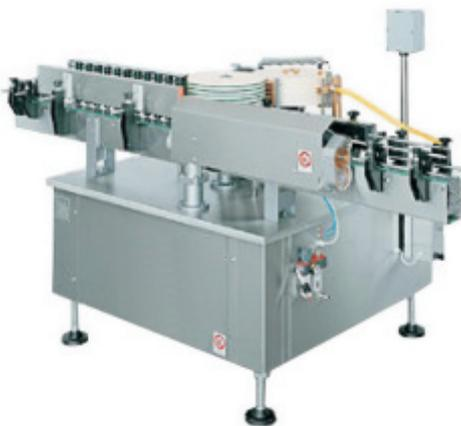
**Линейная этикетировочная машина бумажных** этикеток предназначена для наклейки одной круговой или частичной этикетки на холодном клею на цилиндрический контейнер. На машине установлен подвижный магазин этикеток и входной шнек в комплекте с клеевым насосом. Благодаря вакуумному переносу этикетки на бутылку гарантируется точность нанесения этикетки и долговечность работы машины.
